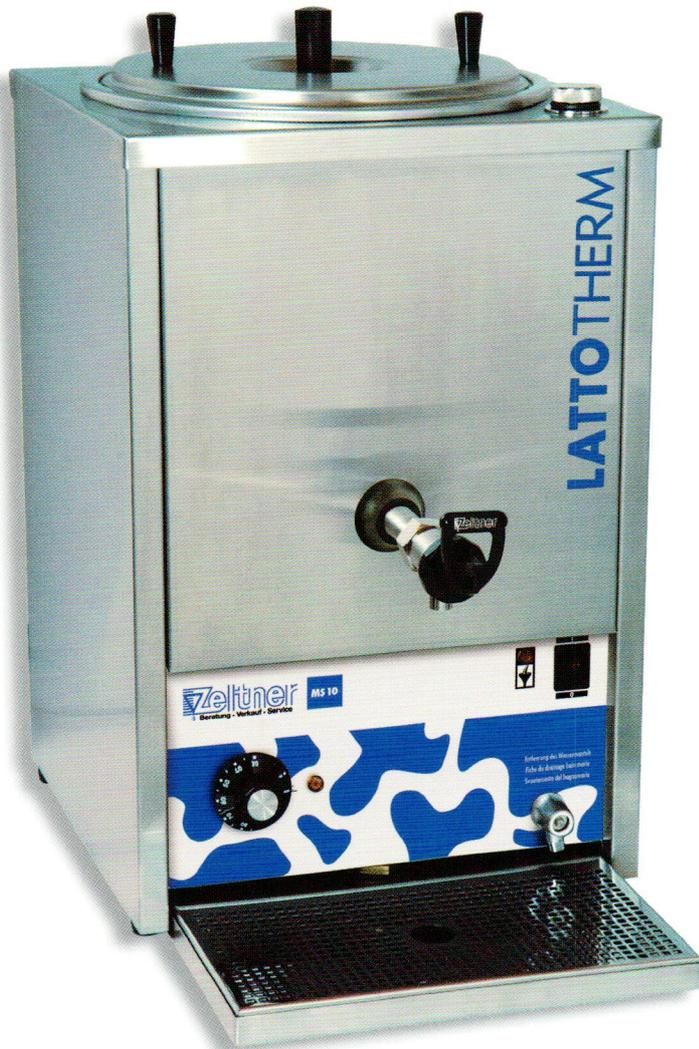
**LattoTherm** erwärmt Milch oder andere Getränke mit einem Wasserbad-System, welches auf folgende Weise funktioniert: In der doppelten Wand um die Milch herum wird Wasser gleichmäßig erwärmt. Die Milch übernimmt die Temperatur des Wärmemantels. Hierdurch erwärmt die Milch schnell, schonend und es wird ein Anbrennen verhindert. Die maximal einstellbare Temperatur beträgt 85°C. Alle **LattoTherm**-Produkte werden aus Edelstahl CrNi 18/8 hergestellt und sind leicht zu reinigen.
